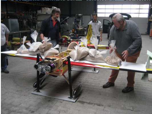
Extra von Markus Rumber, Spannweite 3,85Meter, Gewicht 35kg, 2 E-Motore mit Getriebe
