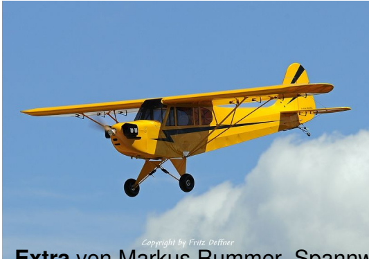
Extra von Markus Rumber, Spannweite 3,85Meter, Gewicht 35kg, 2 E-Motore mit Getriebe
