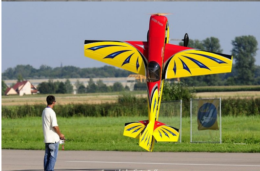
Edge von Günther Hölzlwimmer, Spannweite 3,85Meter, Gewicht 31kg, Motor 275ccm
